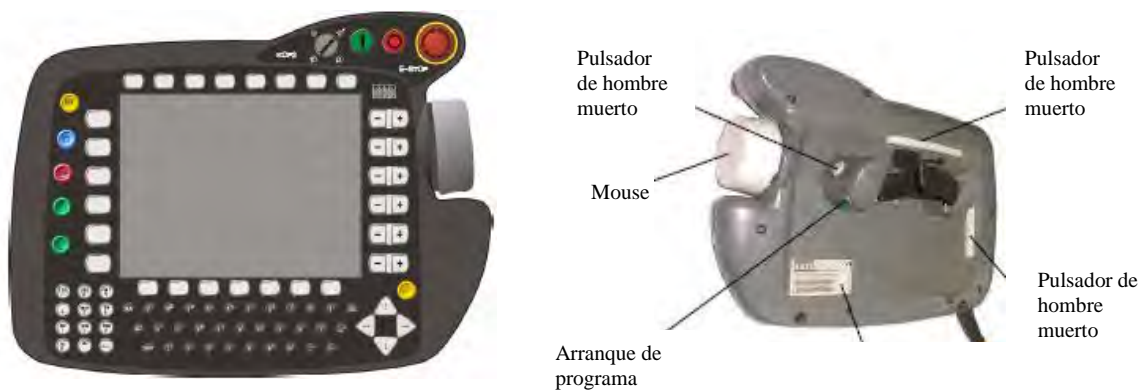
Figura 2.5 Panel de control (KCP)
